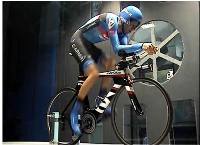
Figura 12 - Ryder Hesjedalin in prova sulla apposita attrezzatura che permette di mettere in rotazione entrambe le ruote.
