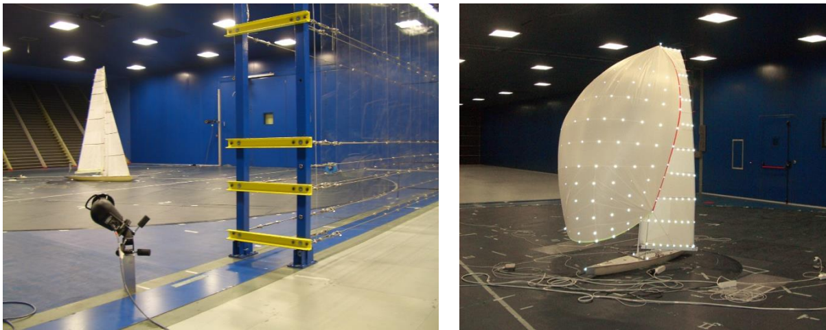
Figura 18 – Misura della forma delle vele con tecniche di acquisizione ed elaborazione delle immagini
