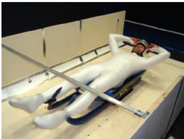
Figura 10 – Armin Zoeggeler in prova utilizzando un'attrezzatura che riproduce il profilo della pista olimpica.
