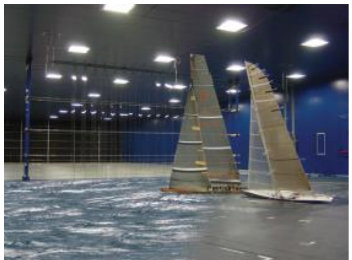
Figura 17 – Prove “Prada” in galleria del vento
