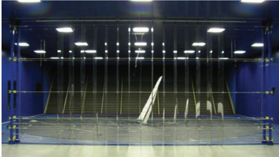
Figura 15 - America's Cup Class Yacht (scala 1:12) durante un test in andatura di bolina
